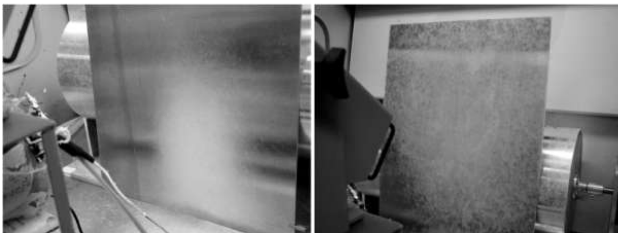
Рисунок 15 – Влияние ионизатора (внизу с ионизатором,верху – без ионизатора) на концентрированность волокон из полистирола на осадительном электроде
