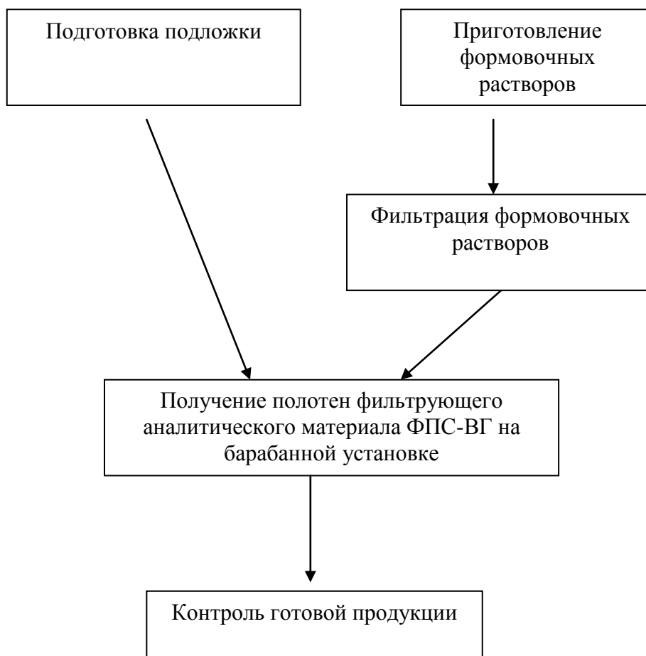
Рисунок 2 - Технологическая схема производства композиционного аналитического фильтрующего материала ФПС-ВГ
